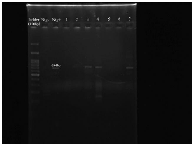
شکل ۳. نتایج ژل الکتروفورز حاصل از PCR نایسریا گنوره آ (694bp) به همراه کنترل مثبت (Nig+) و کنترل منفی (Nig-)
